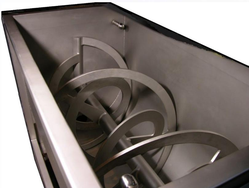
Figure 17 - Vue de l'intérieur d'un mélangeur horizontal à double ruban concentrique.
