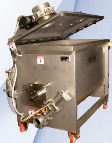
Figure 14- Mélangeur horizontal à double ruban concentrique
